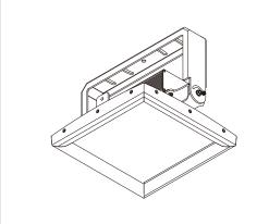
燈具方向調整完成後,請務必將支架上 的法蘭螺帽鎖緊。
